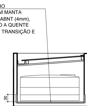
DET. 03 IMPERMEABILIZAÇÃO - CAIXA D'ÁGUA ESCALA.....1/75
