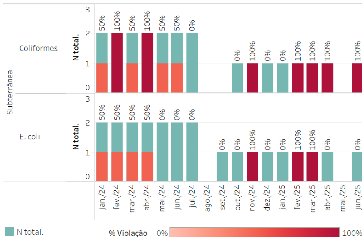
Figura 6-172 - Série histórica dos resultados qualitativos de coliformes totais e E. coli na saída dos pontos sem tratamento, localizados no município de Sooretama-ES.
