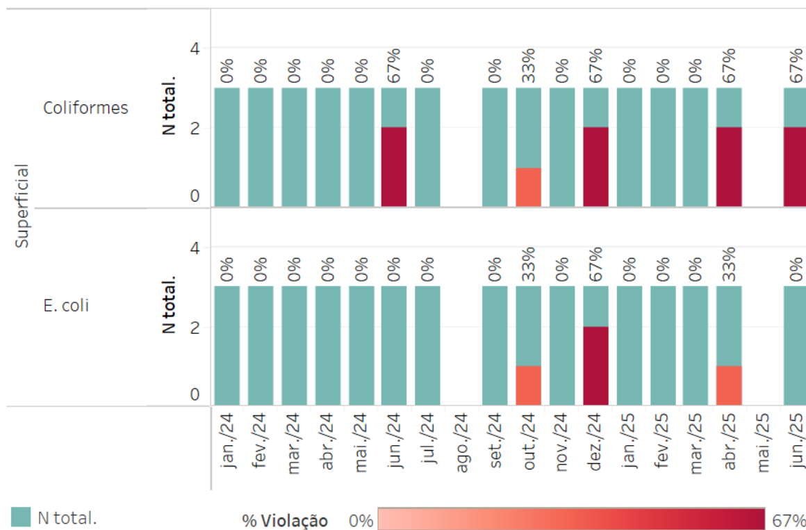
Figura 6-178 - Série histórica dos resultados qualitativos de coliformes totais e E. coli na saída dos pontos com tratamento, localizados no município de Sooretama-ES.
