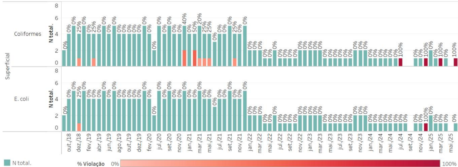
Figura 6-139 - Série histórica dos resultados qualitativos de coliformes totais e E. coli na saída do ponto com tratamento localizado no município de Aimorés- MG.
