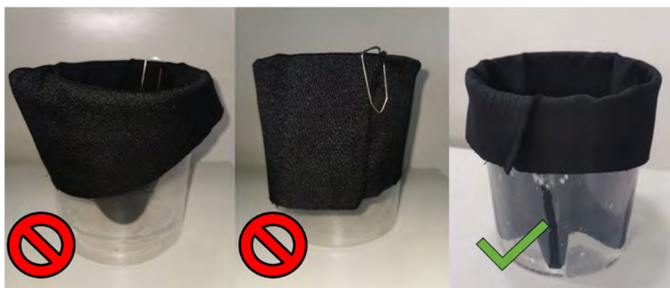
FIGURA 9 Correta instalação da forragem da EDL
