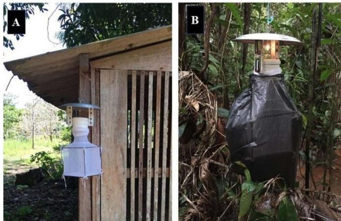
Figura 5 - Armadilha luminosa do tipo CDC. A. CDC instalada no galinheiro; B. CDC com saco plástico para proteção da chuva. Créditos da imagem: Acervo LTDA.
