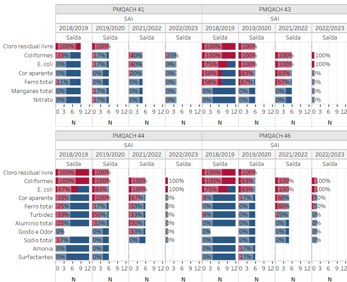
Figura 6-19 - Percentual de violação dos parâmetros monitorados nos pontos PMQACH 41, PMQACH 43, PMQACH 44 e PMQACH 46 localizados no município de Barra Longa-MG, entre setembro/2018 e julho/2023, com base nos limites aplicáveis.
