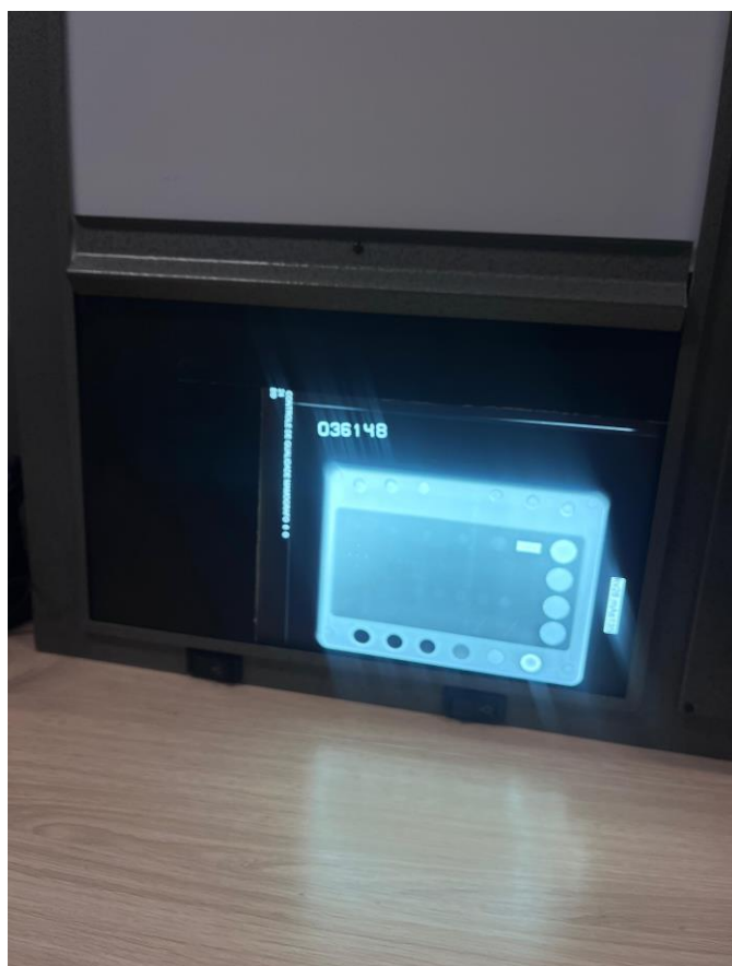
Figura 2 – Imagem do negatoscópio preparado para análise do fantoma CBR
