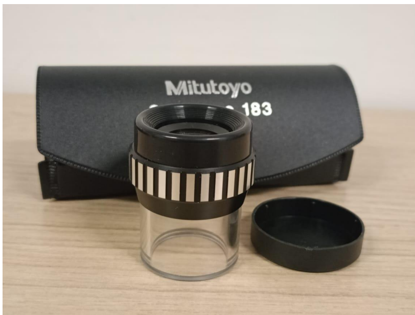
Figura 4 – Lupa de aumento para análise das grades metálicas
