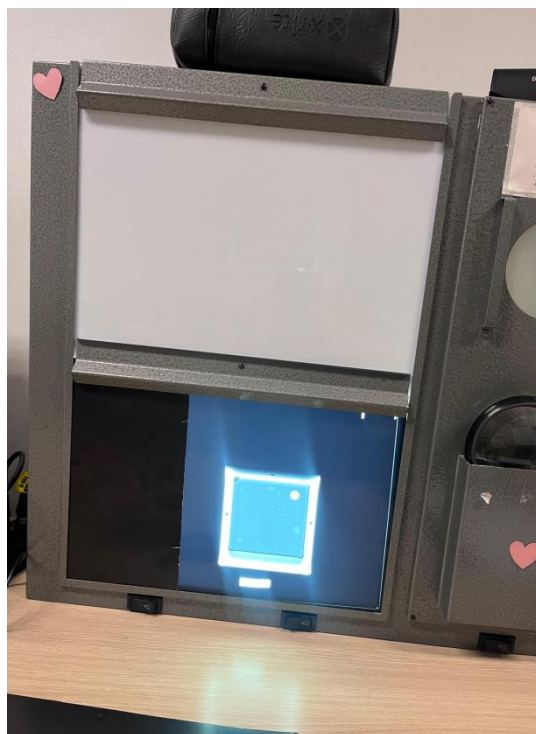
Figura 2 – Imagem do negatoscópio preparado para análise do fantoma ACR
