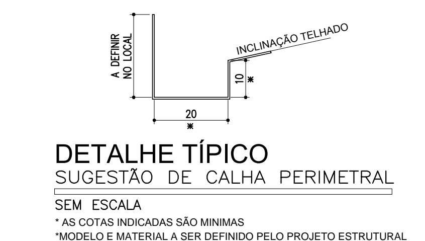
DETALHE TÍPICO SUGESTÃO DE CALHA PERIMETRAL SEM ESCALA
