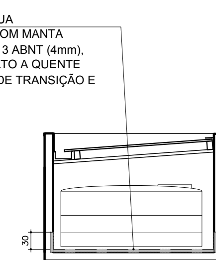
DETALHE 03 IMPERMEABILIZAÇÃO DA CAIXA D'ÁGUA ESCALA.....1/75
